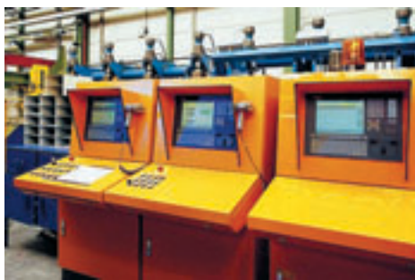
图2 各种机械的中央操控台。每个处理区都利用一个工业IPC实现控制，可视化及通信
