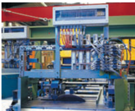
图4 在锯床上，PLC/NC TwinCAT 软件控制着 9 个伺服轴。PC 处理器上计算并循环本地调节器，通过现场总线与驱动，测量系统交换数据
