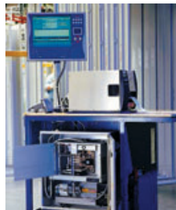
图6 4 个 PC 站在生产线的终端，与控制面板一起，实现适当的控制及检测任务
