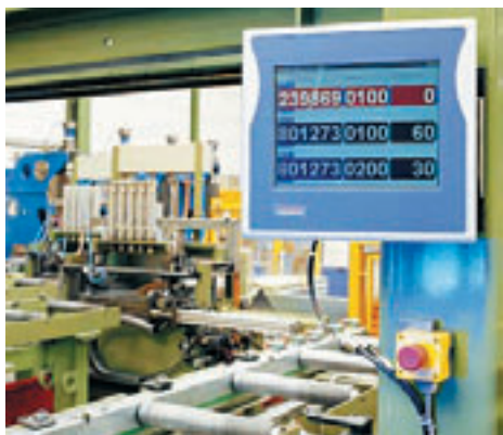
图3 当前的特殊窗框生产状况显示。此处的控制面板仍然使用了 Beckhoff 技术，通过 CP-Link 与相距 65m 的工业IPC连接
