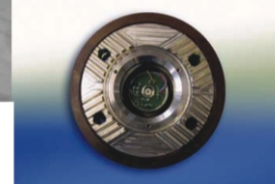
图 5: 为防止不平衡，在中央安装了转子电子装置
