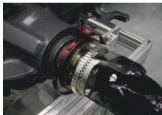
(图1)扭矩传感器： 安装在后轴和方向轴之间
