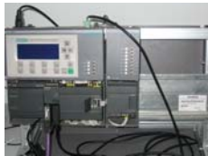
基于PLC触摸屏的温度控制设备(内含温控单元)
