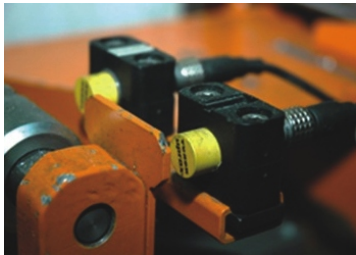
Uprox+ 传感器在车门生产线上的应用
