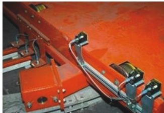
Uprox+传感器在涂装生产线上的应用
