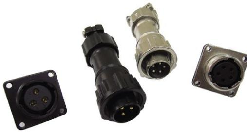
IPX8 防水等级, 除高防水等级外, 本次更突破金属易生锈的缺点, 可达到盐雾 500 小时测试(亦有通过耐盐雾 48 小时测试之产品)。组装方式使用线材范围为  $\phi 5.5\text{mm} \sim \phi 12.5\text{mm}$ , 更以强力夹持方式固定线材, 可耐 30kg 以下吊重; 另外, 产品耐温范围为  $-40^{\circ}\text{C} \sim 105^{\circ}\text{C}$ 。
