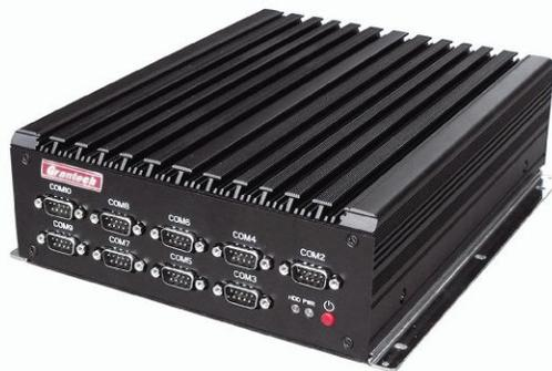
UFO6366E-833-10C 是针对工厂自动化、智能交通、钢铁冶金、混凝土搅拌等行业开发的无风扇工业电脑,其经受了 -10°C~70°C 的环境温度考验,尤其适合高温多尘等恶劣环境的长时间使用。板载低功耗高性能的英特尔凌动 N270 处理器,提供 10 个串口, 2 个千兆网口, 1 个并口, 满足工业现场各种数据传输应用,解决了传统上位机体积大,使用寿命不长,高温易死机等弊端,使恶劣环境的工业应用变得更加安全和省心!
